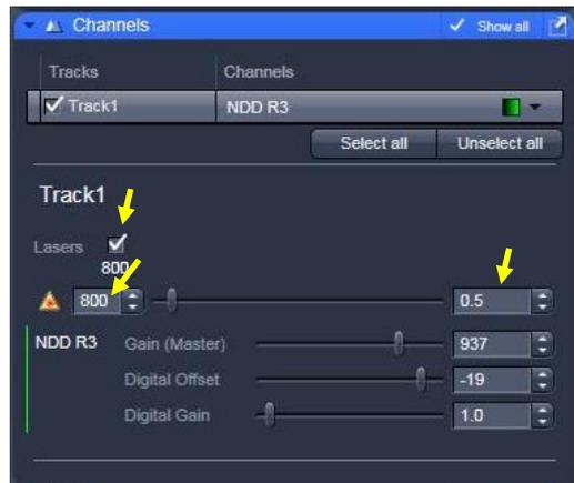
Appliquez un gain (« Gain (master) », l'offset (« Digital Offset »). Il est possible d'augmenter le gain de manière numérique avec le « Digital Gain » : le signal ainsi que le bruit de fond est multiplié par la valeur entrée.
